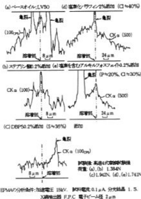
図6. 油中で焼付きを起こさせた回転球と固定球の溶着界面付近で観察されたC K \alpha 線の挙動 (計測法: ASTM, D-2596, 67T)
