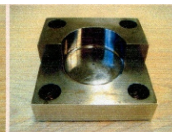
アルミニウム製射出成型金型
